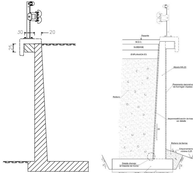
Secciones tipo. Muros
