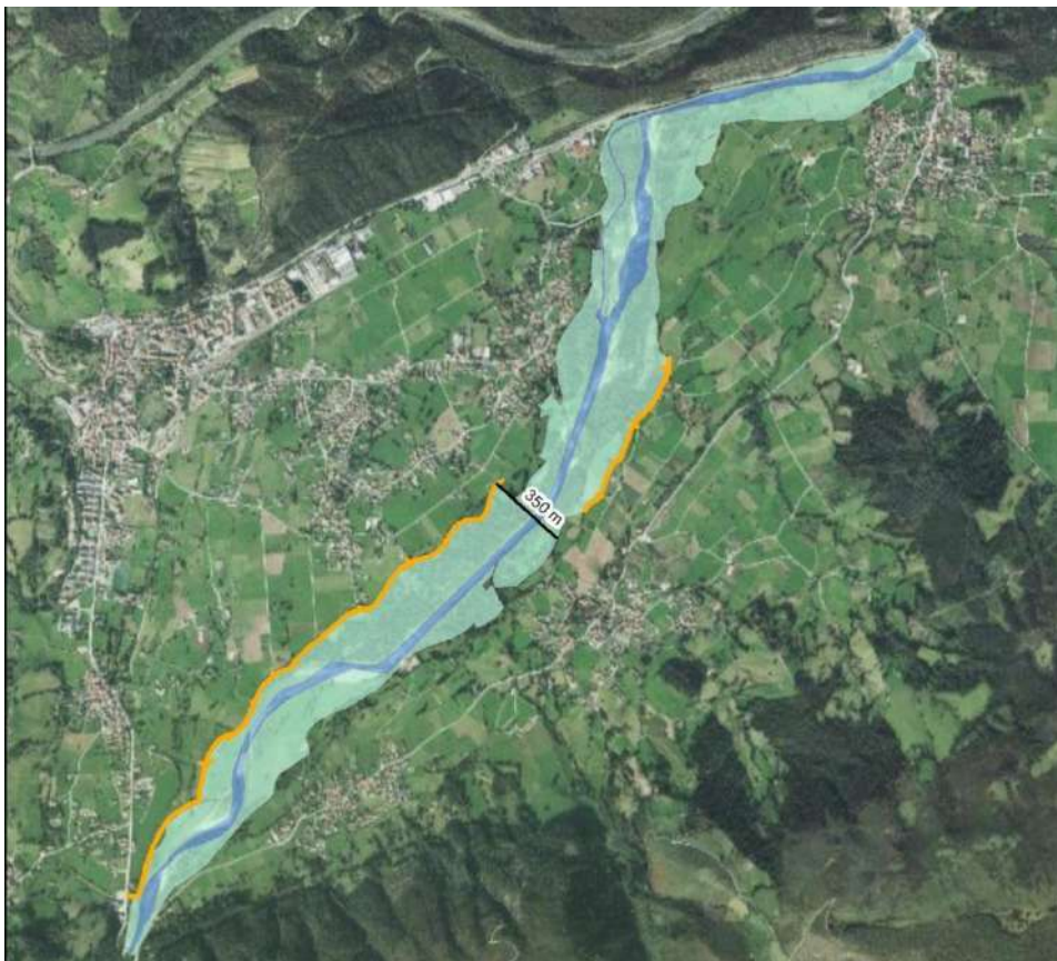
Espacio fluvial público delimitado
